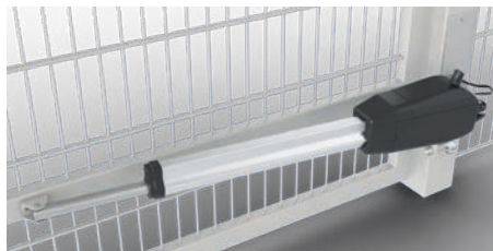
RANKO twist 350 für Drehflügeltore mit bis zu 4 m Torflügelbreite oder 700 kg Torflügelgewicht
